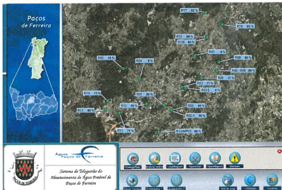
Figura 9: Sistema de telegestão da Águas de Paços de Ferreira
